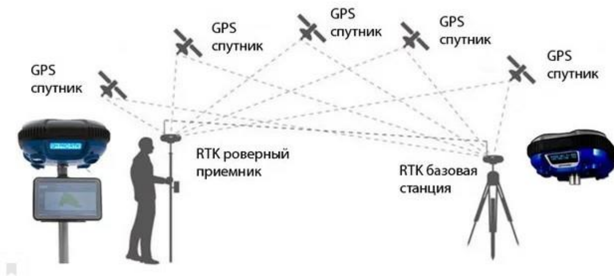
3- сурет – RTK режимінің жұмыс жасау принципі
